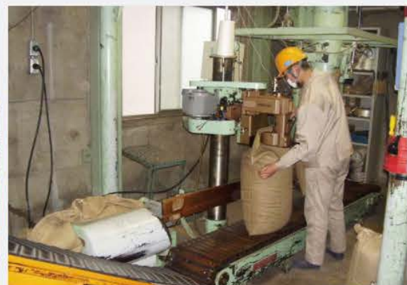
袋詰マシン掛作業
