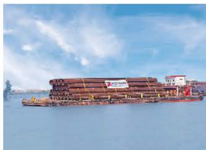
バングラディッシュにて橋脚部材の河川輸送
